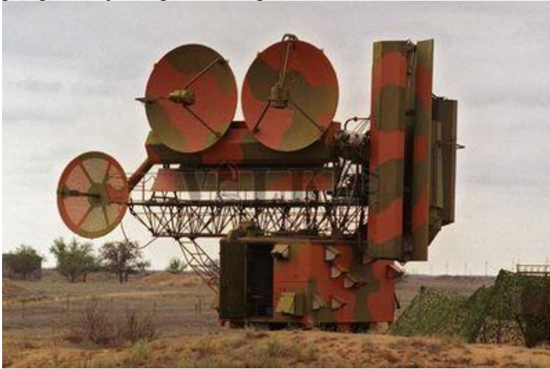
Střelecký naváděcí radiolokátor SNR-75V na polygonu pro ostré školní střelby Ašuluk. Fotografie poskytnuta laskavým svolením p. Petra Kunce, administrátora webu www.fortifikace.net , zdroj obrázku: http://forum.fortifikace.net/viewtopic.php?t=294&start=0
