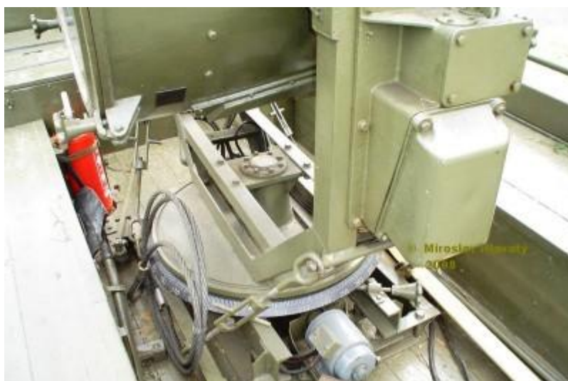
Detaily osadenia svetlometu na korbe.
